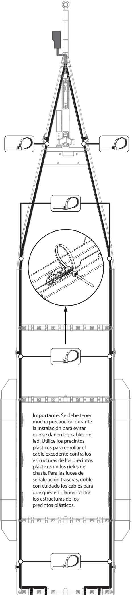
**Importante:** Se debe tener mucha precaución durante la instalación para evitar que se dañen los cables del led. Utilice los precintos plásticos para enrollar el cable excedente contra los estructuras de los precintos plásticos en los rieles del chasis. Para las luces de señalización traseras, doble con cuidado los cables para que queden planos contra los estructuras de los precintos plásticos.
